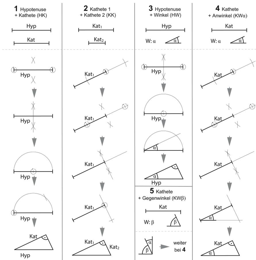
Abb. 3. Konstruktion des rechtwinkligen Dreiecks bei verschiedenen Angaben. Die fett gedruckten Zahlen beziehen sich auf die im Text ausgeführten Fälle.
