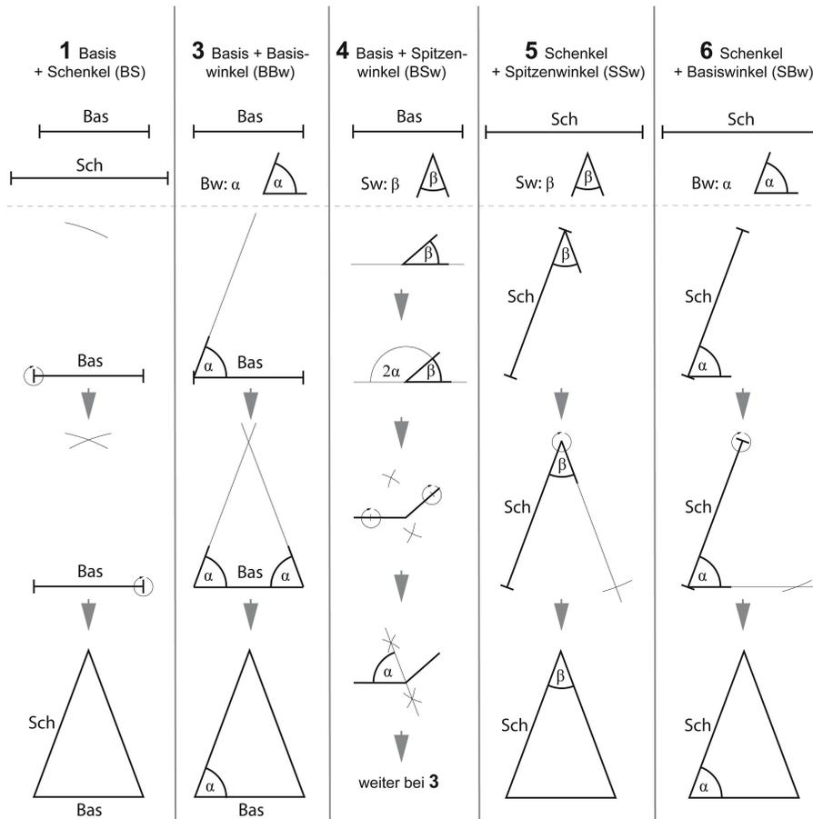
Abb. 2. Konstruktion des gleichschenkeligen Dreiecks bei verschiedenen Angaben. Die fett gedruckten Zahlen beziehen sich auf die im Text ausgeführten Fälle.
