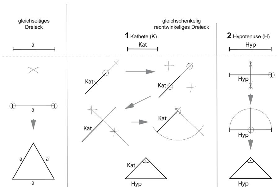
Abb. 4. Konstruktion des gleichseitigen Dreiecks und des gleichschenkelig rechtwinkeliges Dreiecks bei verschiedenen Angaben. Die fett gedruckten Zahlen beziehen sich auf die im Text ausgeführten Fälle.
